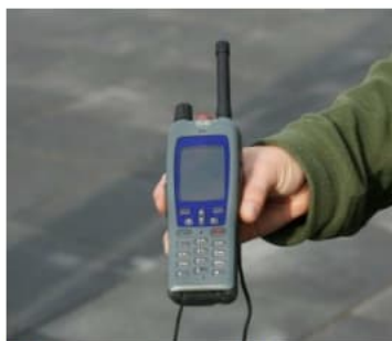
Handgerät der Personennotsignalanlage
