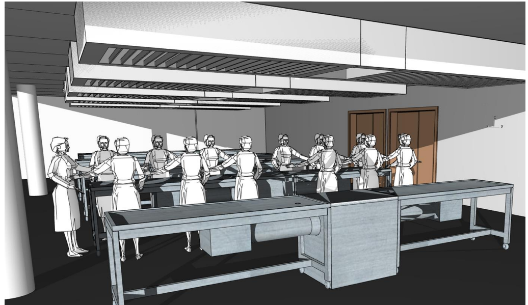
Planung der Präpariertische mit Abluftsystem im Anatomiebereich
