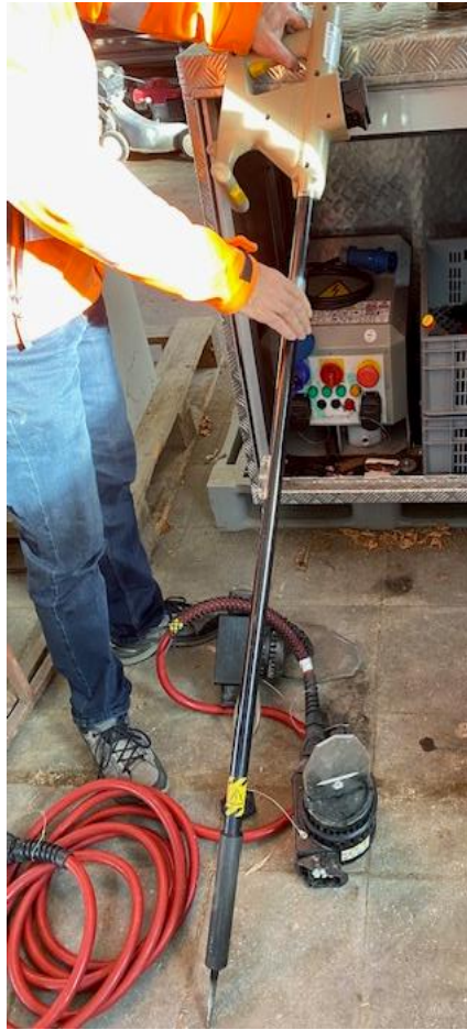
Gerät zur Bekämpfung der Ambrosia im Elektroverfahren
