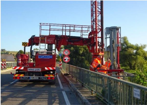
Aufbau des Untersichtgerätes für die Prüfung der Donaubrücke Marxheim
